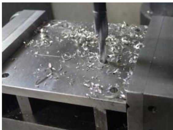
図 1 機械工作・ボール盤による穴あけ
