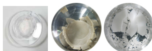
図3 液体酸素適合性試験後の試料外観
