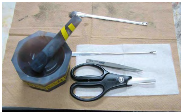
図 2 炭素繊維を粉末化するための道具
