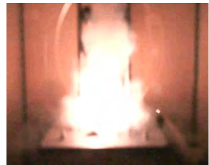
図4 着火時の画像（CFRP）
