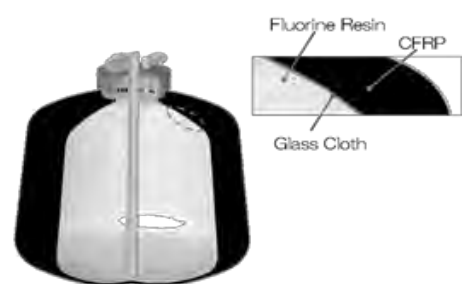
図6 液体酸素タンクの構造
