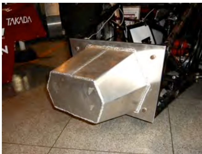
図4 車両先端に取り付けているインパクトアッテネータ
