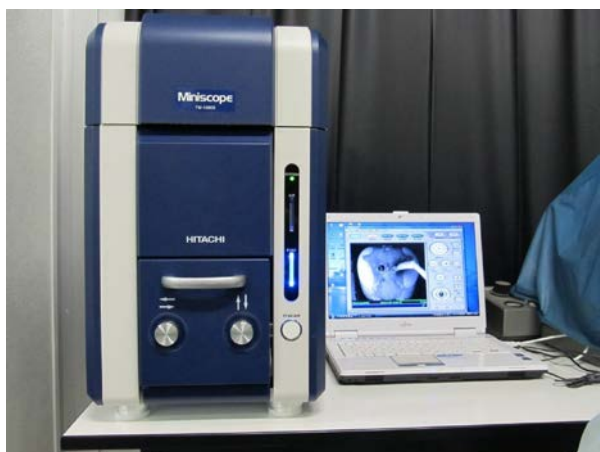
図3 日立卓上顕微鏡 Miniscope® TM3000
