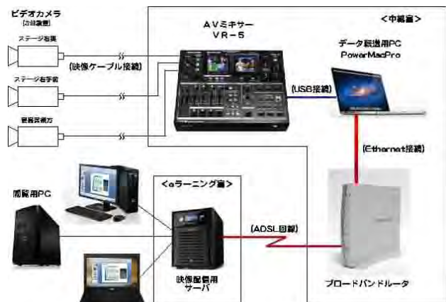
図1 入学式中継のための機材構成
