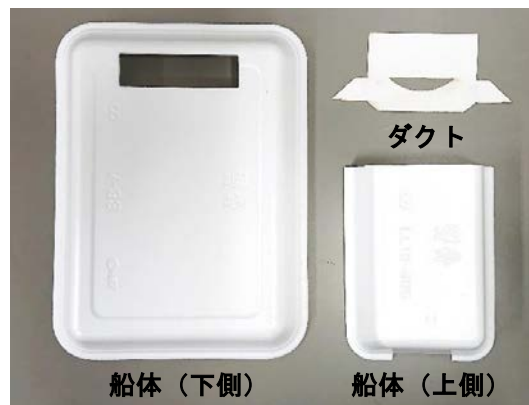
図 3 加工後の船体とダクト
